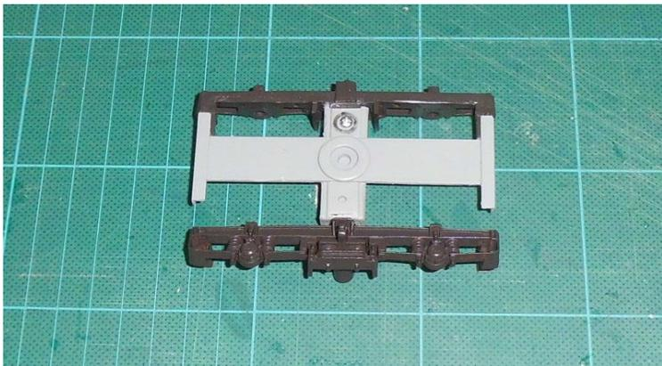
Die Drehgestelle werden mit Metall Radsätze bestückt, (statt mit Kunststoff Räder) und in die Gleitlager montiert.
