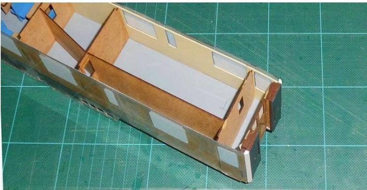
Vorerst wird die Stirnseite zusammengebaut mit Teile, ausgelasert in 1 mm. MDF.
