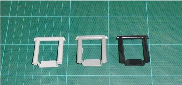
Das Dach wird auf das Gehäuse gesetzt und verriegelt mit den Wülsten an die Stirnseite. Kupplungen werden montiert.
