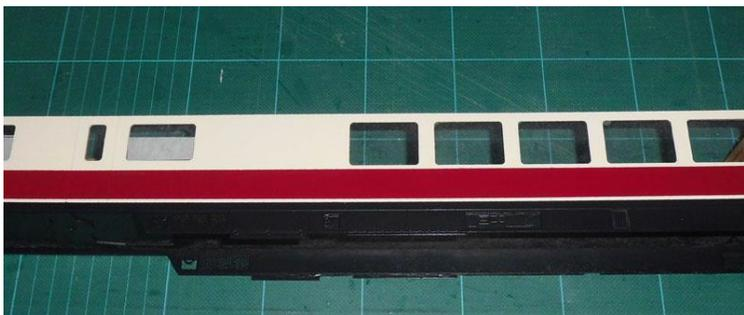
Nachdem die Fensterrahmen, (ausgelasert in Bristol), grundiert und Alufarbig angestrichen sind, werden die auf das Gehäuse geklebt.
