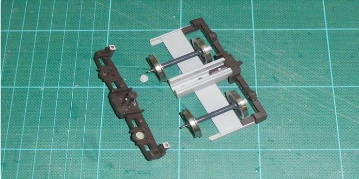
Die Drehgestelle werden montiert und angeschraubt.
